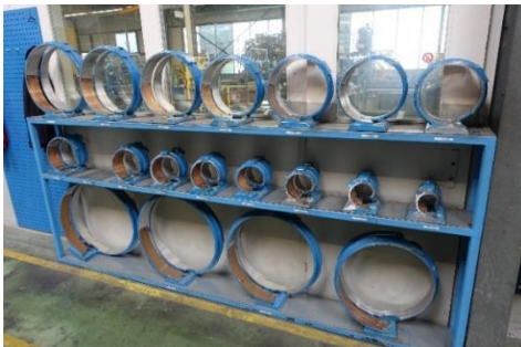
Rohrformen von D = 80 – 2200 mm
